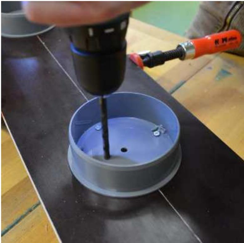
Auch in diese Abflusstropfen bohren wir mit einem 8mm-Bohrer ein paar Löcher.
