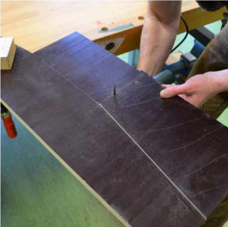
Wenn beide Stirnseiten gesägt sind, könnt ihr sie mit den beiden Sieb-Film-Platten in 16mm Stärke und den Maßen 1232mm x 150mm auf einer geraden Unterlage einspannen.
