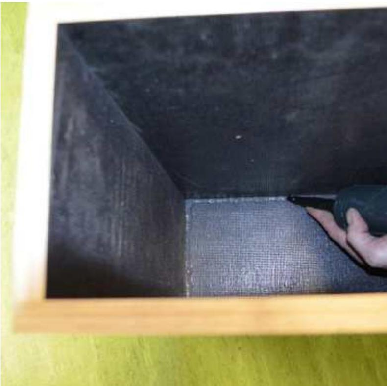
Nachdem wir den Tank von allen Bohrspänen gereinigt haben, versiegeln wir im Wassertank die Ecken mit einem Dachdecker-Silikon, damit der Tank dicht ist.
