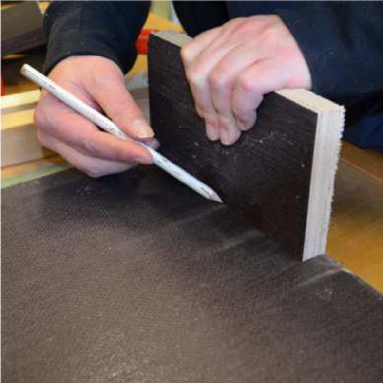
Für das Antragen der 21mm breiten Markierungen an den kurzen Seiten der Platte nutzen wir ein Reststück Holzplatte von 21mm Stärke.
