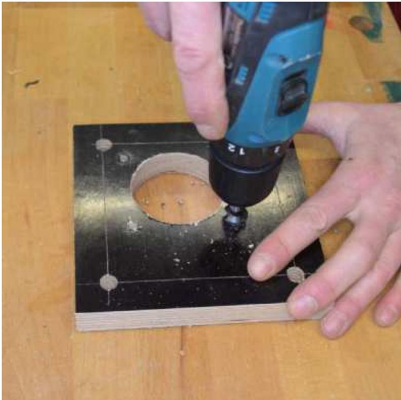
Die Bohrlöcher müssen natürlich auch noch mit dem Senkbohrer bearbeitet werden.
