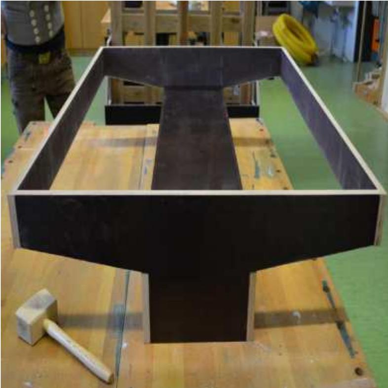
Diese sind aus einer 16mm starken Sieb-Film-Platte mit den Maßen 1200mm x 292mm.
