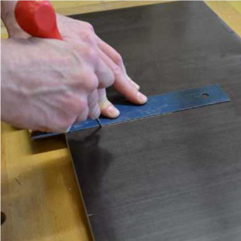
Mit dem Anschlagwinkel ziehen wir eine rechtwinklige Linie auf die linke äußere Markierung.
