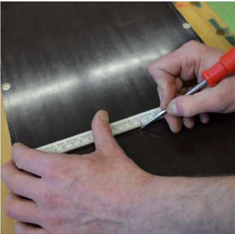
Nun tragen wir von einer Kante der Deckplatte die Hälfte der Deckplattenbreite, also 146mm, ab und erhalten so einen Punkt, den wir markieren.
