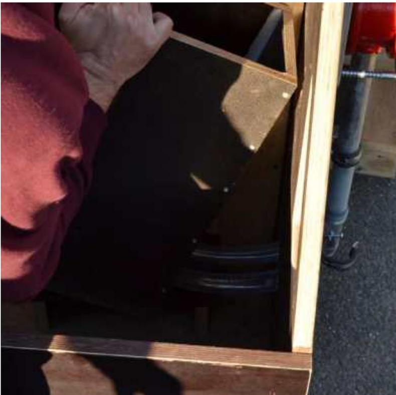
Da wir die beiden PVC-Schlauchstücke an den Auslässen des Wassertanks gelassen haben, führen wir den Wassertank so schräg ein, dass die beiden Schlauchenden in die dafür vorgesehenen Bohrungen rutschen.
