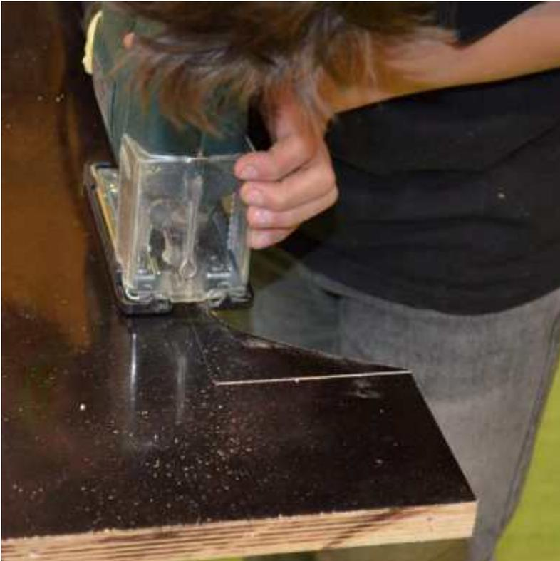
Im letzten Schnitt setzen wir die Säge am Anriss an und sägen wieder zum Schnittpunkt zurück.
