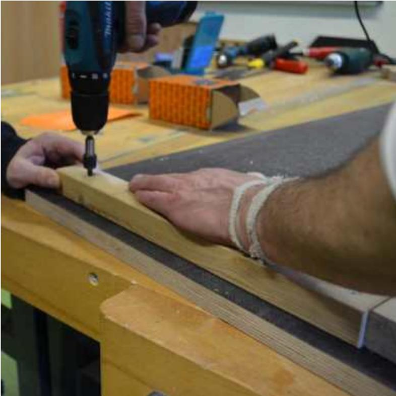
Alle Lattenstücke können jetzt auf der Längsseitenplatte verschraubt werden.
