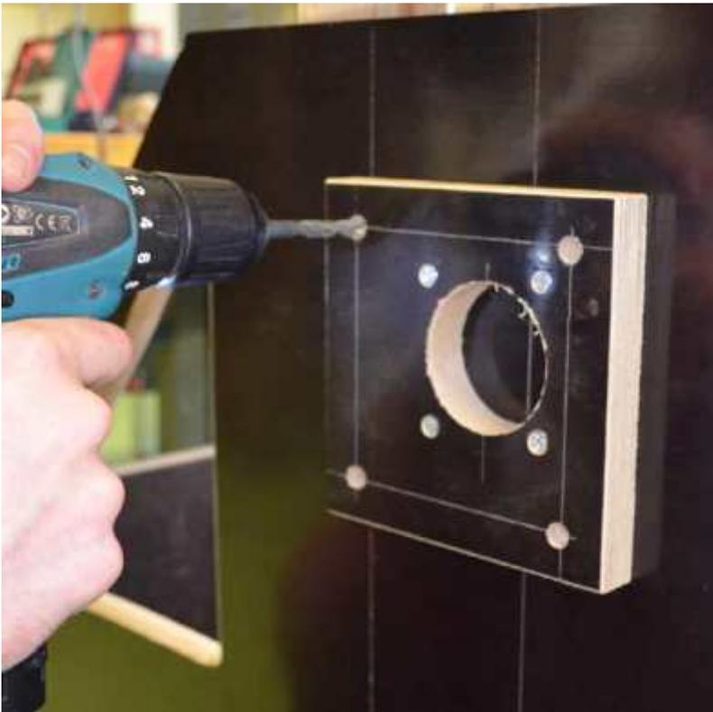
Wenn die innere Halteplatte mit allen vier Schrauben fest ist, können wir die Bohrungen in den Ecken mit einem 10mm Holzbohrer durch die vorhandenen Löcher in die Stirnseite bohren.
