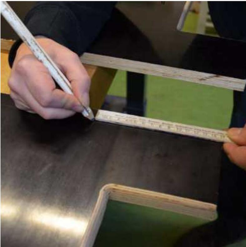
Auch im unteren Teil befindet sich keine Latte, da dieser Teil über der Europoolpalette liegt. Hier zeichnen wir die erste Bohrung 150mm oberhalb der Unterkante an.
